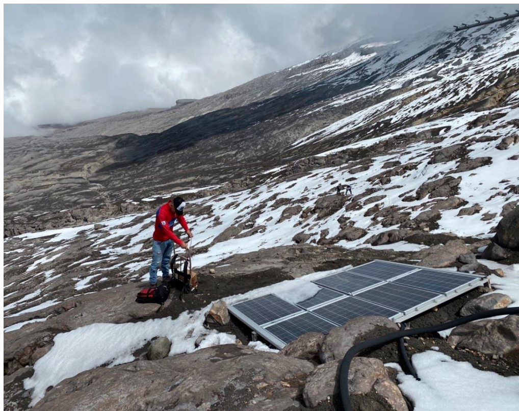
Figura 3. Estación multiparamétrica BIS en el volcán Nevado del Ruiz
